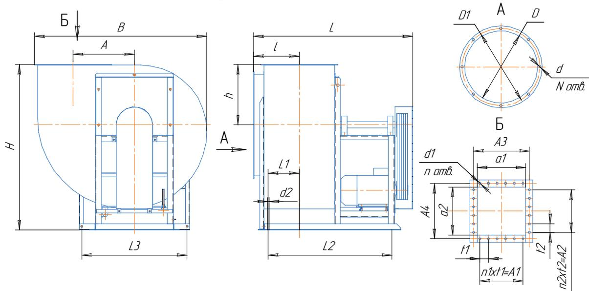
Габаритные и присоединительные размеры вентиляторов ВР 80-75 исполнение 5-02
