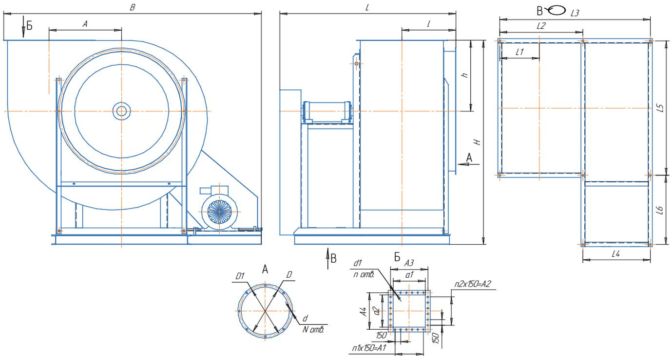
**Габаритные и присоединительные размеры вентиляторов ВР 80-75 исполнение 5-01.**
