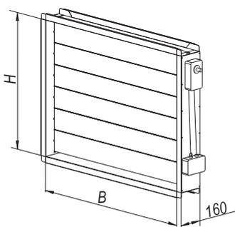
Клапан утепленный состоит из четырех-стеночного корпуса, выполненного из оцинкованной стали. Лопатки изготовлены из алюминиевого профиля. Примыкание лопаток представлено в виде замкового уплотнения. Лопатки заслонки раскрываются параллельно и приводятся в движение с помощью системы рычагов и тяг.
