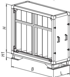
Секция фильтрации комплектуется блоками фильтров грубой или тонкой очистки. Фильтрующие элементы устанавливаются в монтажные рамки, которые фиксируются в направляющих корпуса. Такая конструкция позволяет при необходимости производить быструю замену фильтров. Фильтры состоят из вставленного в стальную рамку фильтрующего материала из синтетических волокон. Фильтрующие элементы имеют толщину 25 или 50 мм.
