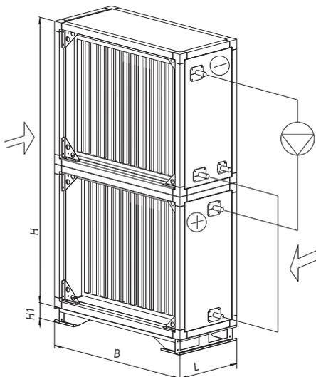
Данная схема утилизации тепла применяется в системах кондиционирования помещений с самыми жесткими требованиями к чистоте воздуха, так как каналы приточного и вытяжного воздуха полностью разделены, а также в случае большого расстояния между приточной и вытяжной установкой.
