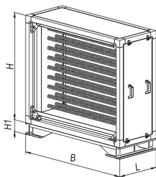
Блок воздушного нагревателя предназначен для нагрева воздуха, подаваемого кондиционером в обслуживаемое помещение.
