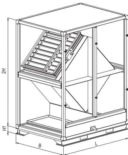
Вытяжной, удаляемый из помещения, воздух, протекает в канале между пластинами теплообменника, нагревая их. Приточный воздух протекает через остальные каналы теплообменника и поглощает тепло нагретых пластин.
