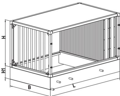
Предназначена для адиабатического увлажнения воздуха. В комплект поставки входят: пластиковые форсунки, гидромодуль, каплеуловитель и поддон. Распыление воды осуществляется по направлению потока воздуха. На выходе секции установлен пластиковый каплеуловитель для улавливания уносимых потоком воздуха капель воды. Под секцией находится поддон, в который стекает неиспарившаяся вода. Насос осуществляет циркуляцию воды из поддона к форсункам.
