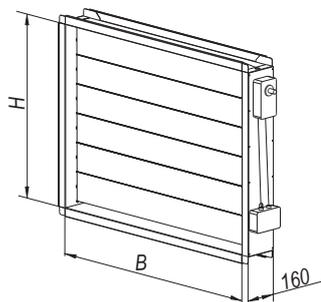
Лопатки выполнены из усиленного алюминиевого профиля. Примыкание створок выполнено в форме замкового уплотнения.
