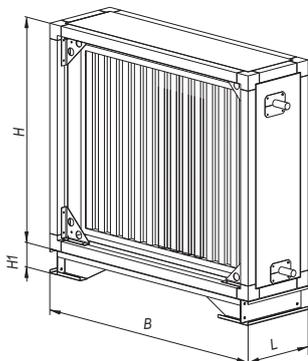
Блок водяного нагревателя предназначен для нагрева подаваемого в обслуживаемое помещение воздуха или газовых смесей, не содержащих клейких, волокнистых и твердых примесей.
