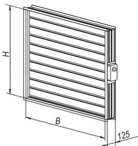
Воздушные клапаны выполнены по одной конструктивной схеме и состоят из корпуса и поворотных лопаток, единых по сечению для клапанов всех типоразмеров, подшипников скольжения, уплотнителей и привода. Лопатки изготавливаются из специальных фасонных профилей. Для вращения используются пластмассовые шестерни и подшипники скольжения.
