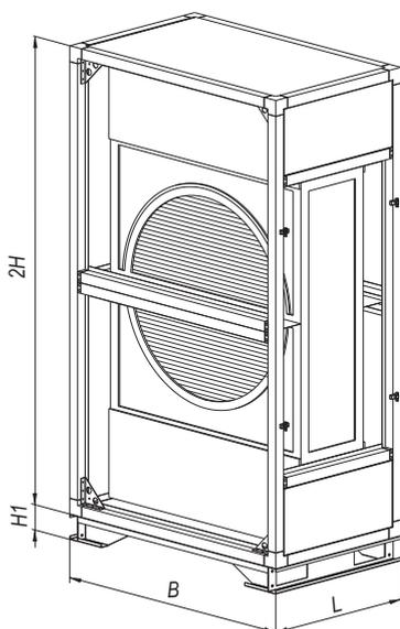
Данный тип рекуператора применим при непосредственной компоновке приточной и вытяжной установок и допускает некоторое смешение приточного воздуха с удаляемым (не более 5%).
