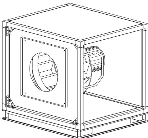
Один из вариантов комплектации вентблока – ЕС-вентилятор, то есть вентилятор, который приводится в движение ЕС-двигателем. ЕС-двигатель – это бесколлекторный синхронный двигатель со встроенным электронным управлением, или, более кратко, электронно-коммутируемый (Electronically Commutated) двигатель.
