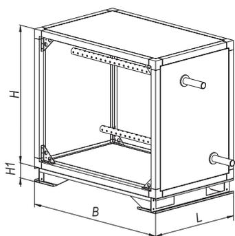
Увлажнение воздуха в данном блоке происходит за счет введения в воздушный поток пара вырабатываемого парогенератором (не входит в комплект поставки). Для равномерного увлажнения воздуха пар вводится под давлением через гребенки (трубки с продольными рядами отверстий (сопел) - не входят в комплект поставки), количество которых подбирается в зависимости от требуемой эффективности увлажнения. Максимальная эффективность увлажнения до 95%.
