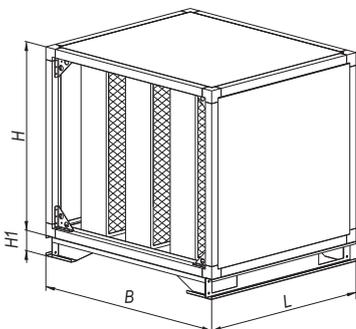
Секция шумоглушения используется для снижения уровня звукового давления от работающего оборудования кондиционера, состоит из корпуса и установленных в нем шумоглушающих пластин.
