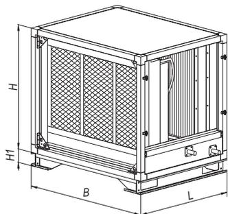
В сотовом увлажнителе происходит адиабатическое увлажнение воздуха циркуляционной водой, поступающей из поддона. Обрабатываемый воздух насыщается водой, двигаясь через кассету, которая состоит из композитного материала. Увлажнитель подключается к источнику холодного водоснабжения с давлением 1-10 бар. Вода, стекая по поверхности кассеты увлажнителя, частично испаряется, а остальная стекает в поддон.
