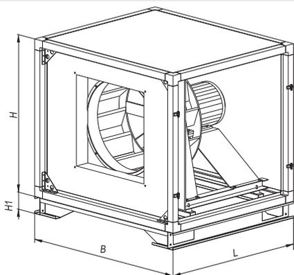
В вентиляторах со свободным рабочим колесом электродвигатель находится на одном валу с колесом вентилятора, поэтому изменение числа оборотов рабочего колеса возможно лишь с помощью регулятора частоты вращения.
